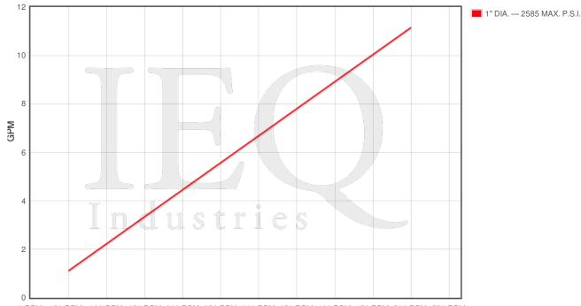
0 RPM 50 RPM 100 RPM 150 RPM 200 RPM 250 RPM 300 RPM 350 RPM 400 RPM 450 RPM 500 RPM 550 RPM 0.0 HP 1.9 HP 3.7 HP 5.6 HP 7.5 HP 9.3 HP 11.2 HP 13.1 HP 15.0 HP 16.8 HP 18.7 HP 20.6 HP
